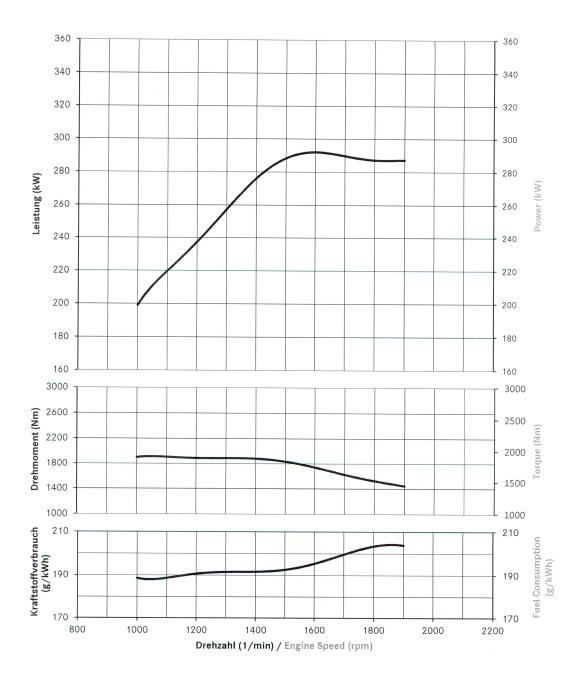
Leistung, Drehmoment OM 460, 290 kW bei 1600/min, Euro III 1900Nm bei 1100/min
